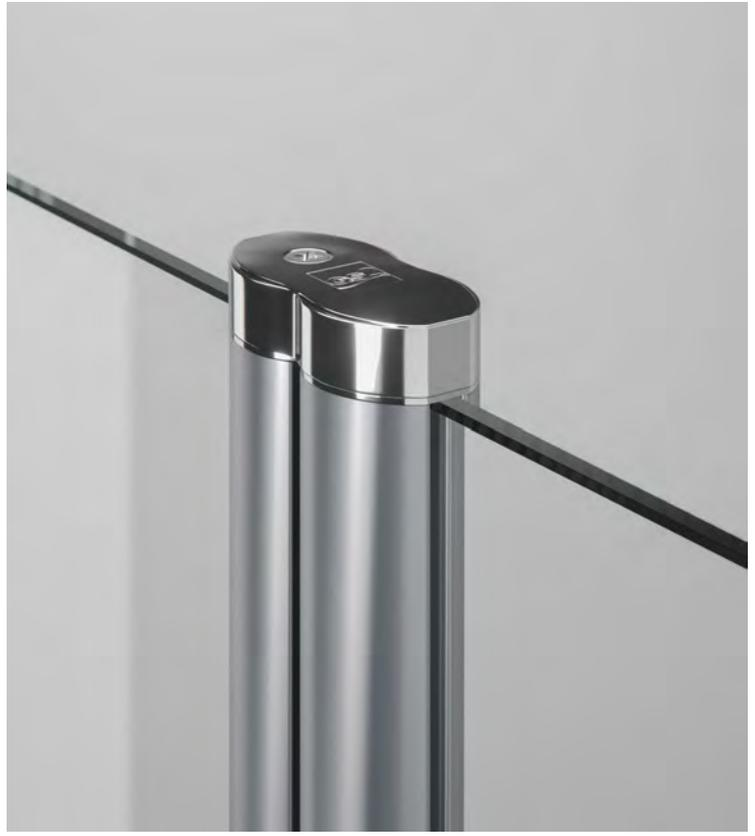
El perfil pivotante tiene un sistema de elevación al abrir la puerta para evitar que roce la goma vierteaguas inferior en el suelo.
