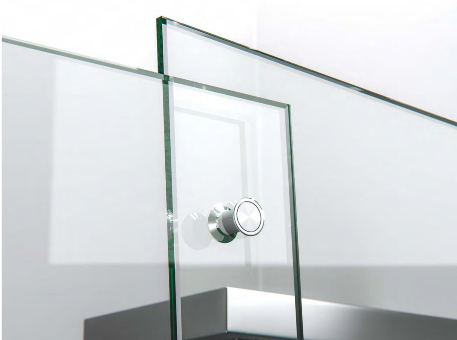
Los vidrios quedan unidos entre sí por mediación de un casquillo separador al cual se atornillan los vidrios directamente. Todo el sistema de fijación queda enrasado a los vidrios para facilitar la limpieza de los mismos.
