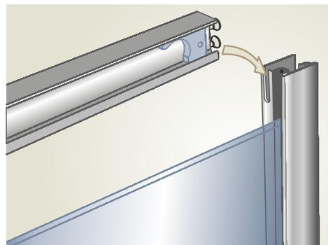
El sistema de anclaje S.F.R., permite ensamblar todo el conjunto de la mampara sin necesidad de destornilladores. Simplemente hay que introducir las guías en los marcos y ¡nada más!
