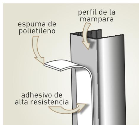
Las bandas adhesivas Quick System® se componen de una espuma de polietileno fungicida que se adaptan a todo tipo de superficies. Gracias a Quick System® es ¡pegar, sellar y listo!
