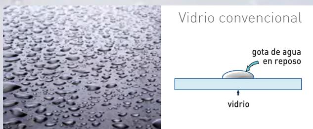
El vidrio con tratamiento totalCLEAN®, la gota de agua al tener menos superficie de contacto es más difícil que se adhiera al vidrio, en cambio en un vidrio convencional, la superficie de contacto aumenta quedando la gota adherida al vidrio con suma facilidad.
